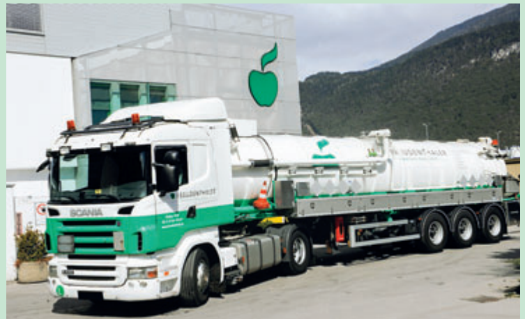
Mit dem Sattel-Saugtankwagen können über 20 Tonnen über gefährliche Flüssigabfälle transportiert werden.
